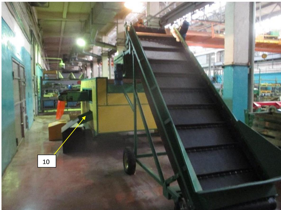
*Рисунок 4.13 – Общий вид загрузочного транспортера опытного образца калибратора с интенсификатором: 10 – скатной лоток для отходов*
