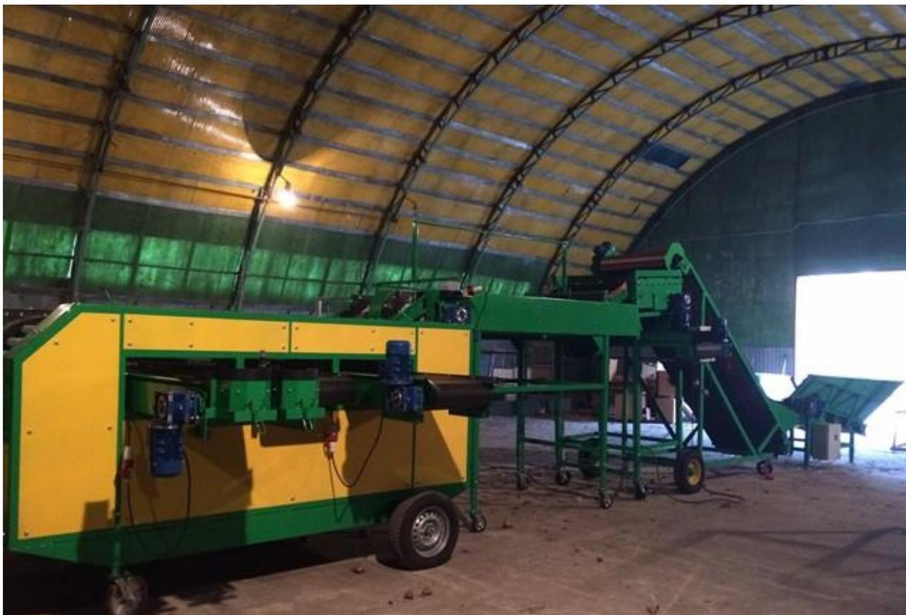
*Рисунок 4.16 – Опытный образец линии для послеуборочной обработки лука с роликовым калибратором, оснащенный эластичными интенсификаторами
