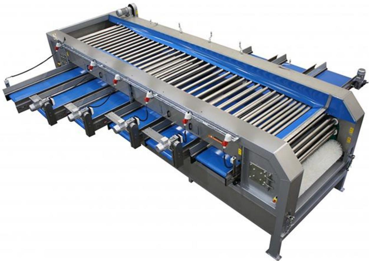
*Рисунок 1.24 – Общий вид калибровочной машины с транспортером роликового типа*
