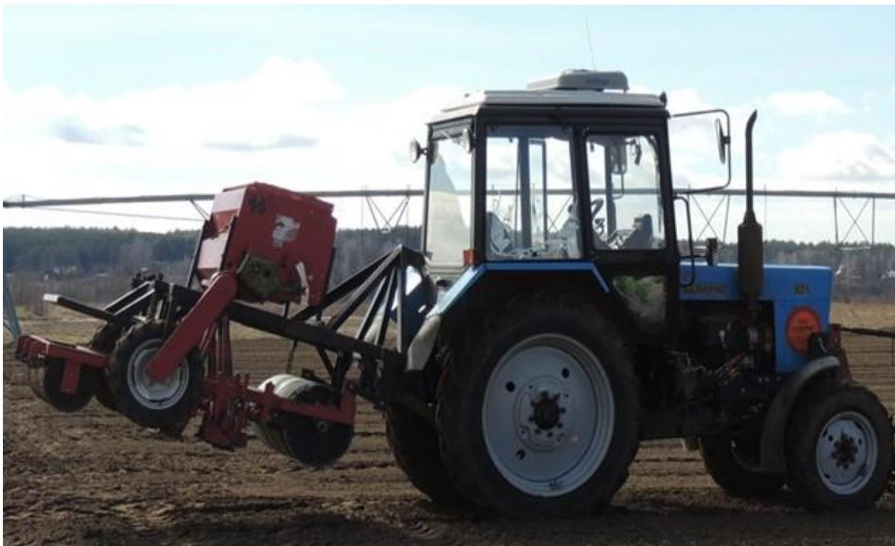
*Рисунок 4.7 – Общий вид посевного агрегата МТЗ-82.1+посевная машина, оснащенная сошником для ленточного посева с распределителем-отражателем изотонного типа*
