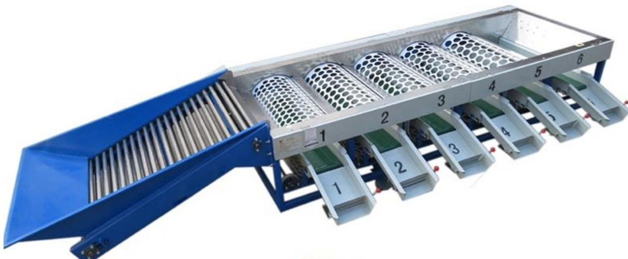
*Рисунок 1.25 - Общий вид калибровочной машины барабанного типа с круглыми отверстиями*
