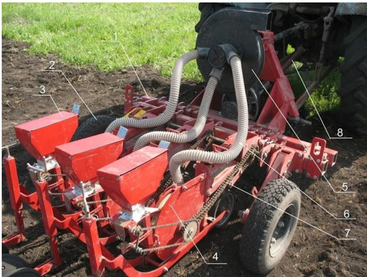
*Рисунок 1.21 – Общий вид посадочной машины оснащенной вибрационно-пневматическим высаживающим аппаратом: 1 – рама; 2 – опорно-приводное колесо; 3 – бункер; 4 – посадочная секция аппарат; 5 – вентилятор; 6 – вакуумопровод; 7 – цепь; 8 – карданный вал*
