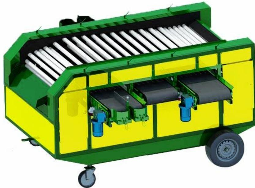
Рисунок 3.23 – Общий вид роликового калибратора с эластичными интенсификаторами
