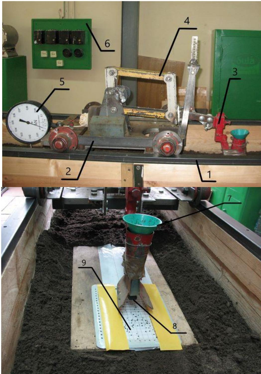
Рисунок 4.2 – Почвенный стенд для проведения исследований сошника для ленточного посева семян лука: 1 – почвенный канал; 2 – тележка; 3 – исследуемый сошник; 4 – рама с механизмом регулирования положения сошника; 5 – электропривод с динамометром; 6 – пульт управления; 7 – воронка; 8 – экспериментальный распределитель-отражатель; 9 – липкая лента с учетными квадратами.
