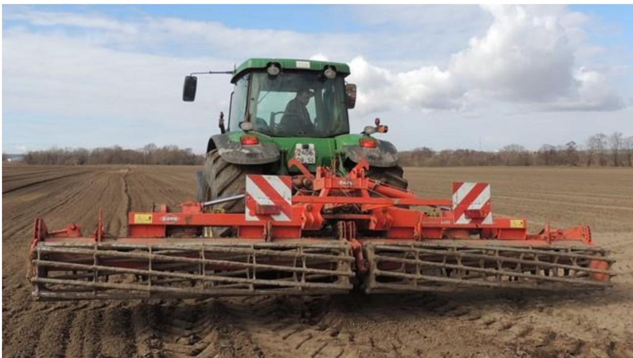
*Рисунок 1.10 – Вертикально-фрезерный культиватор в агрегате с трактором John Deere*
