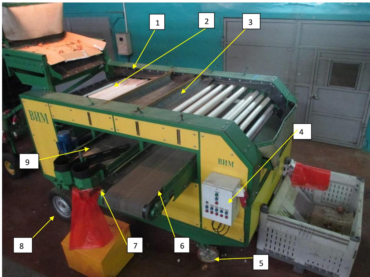
*Рисунок 4.12 – Общий вид роликового калибратора с эластичным интенсификатором: 1 – рама; 2 – полотно роликовое; 3 – эластичные интенсификаторы; 4 – шкаф управления; 5 – колесо опорно-поворотное; 6 – транспортёр средней фракции; 7 – мешкодержатель; 8 – колесо ходовое; 9 – транспортёр мелкой фракции*
