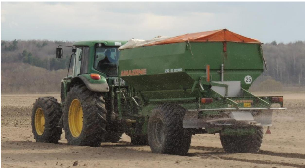
*Рисунок 1.5 – Разбрасывание минеральных удобрений распределителем ZG-B фирмы Amazone*
