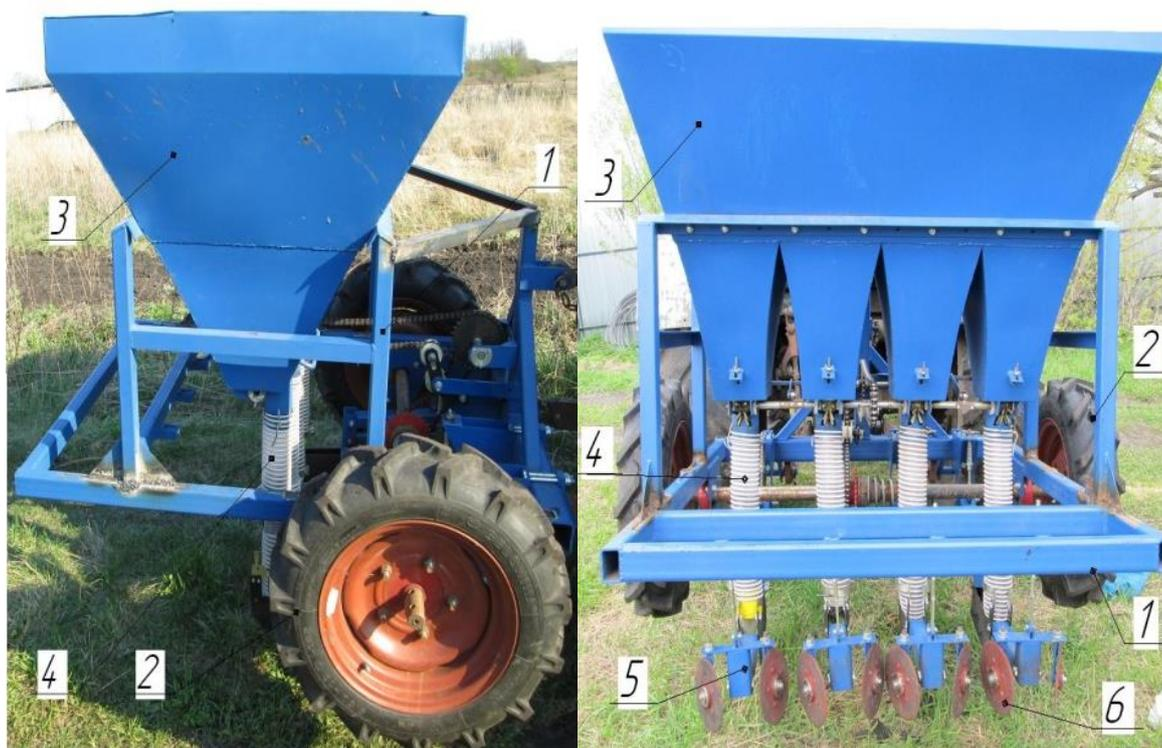
*Рисунок 4.22 - Общий вид опытного образца посадочной машины, оснащенной катушечно-вилчатым высаживающим аппаратом для ориентированной посадки лука-севка: 1 – рама; 2 – опорно-приводное колесо; 3 – бункер; 4 – семяпровод с сошником; 5 – сошник; 6 – заделывающий диск*
