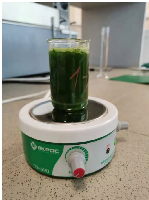
Рисунок 37 – Смешивание навески измельченного материала с алюмокалиевыми квасцами на магнитной мешалке ПЭ-6110
