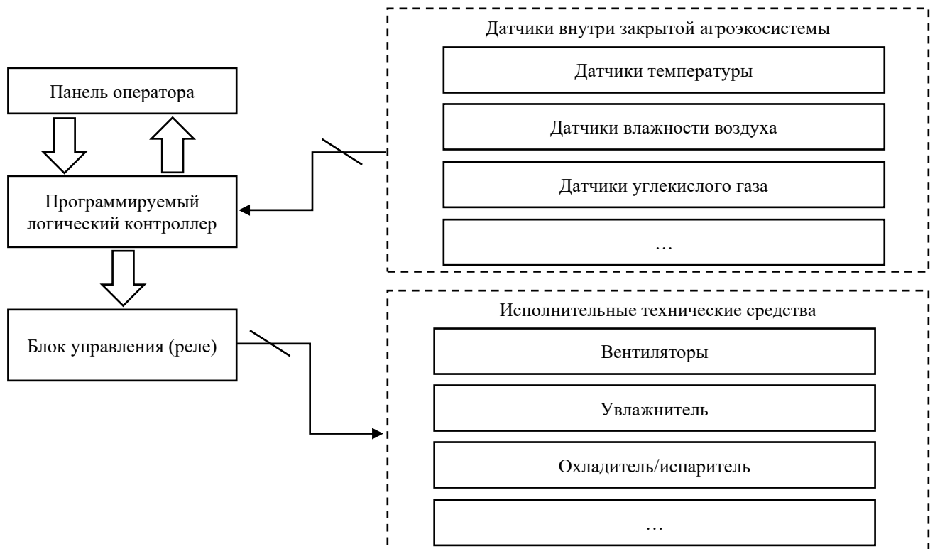
Рисунок 8 – Структурная схема управления микроклиматической системой
