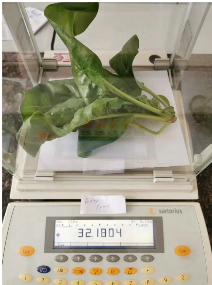
Рисунок 33 – Определение сырой массы растения на лабораторных весах серии Sartorius LA230S
