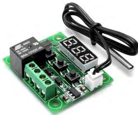
Рисунок 23 – Программируемый терморегулятор W1209
