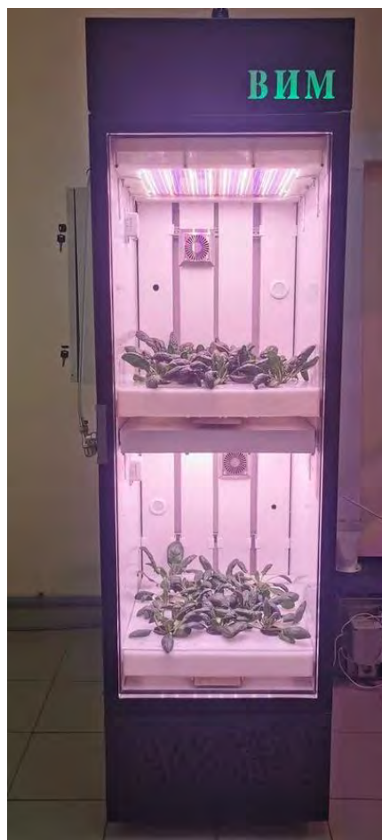
Рисунок 32 – Общий вид климатической камеры с закрытой агроэкосистемой для выращивания зеленных культур
