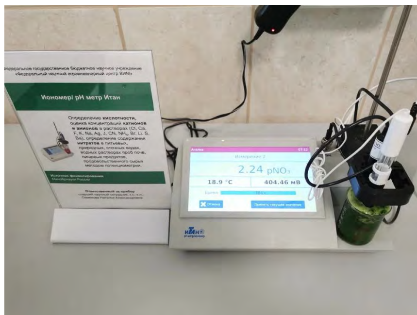
Рисунок 38 – Определение концентрации нитрат-иона с помощью рН-метра – иономера «Итан»
