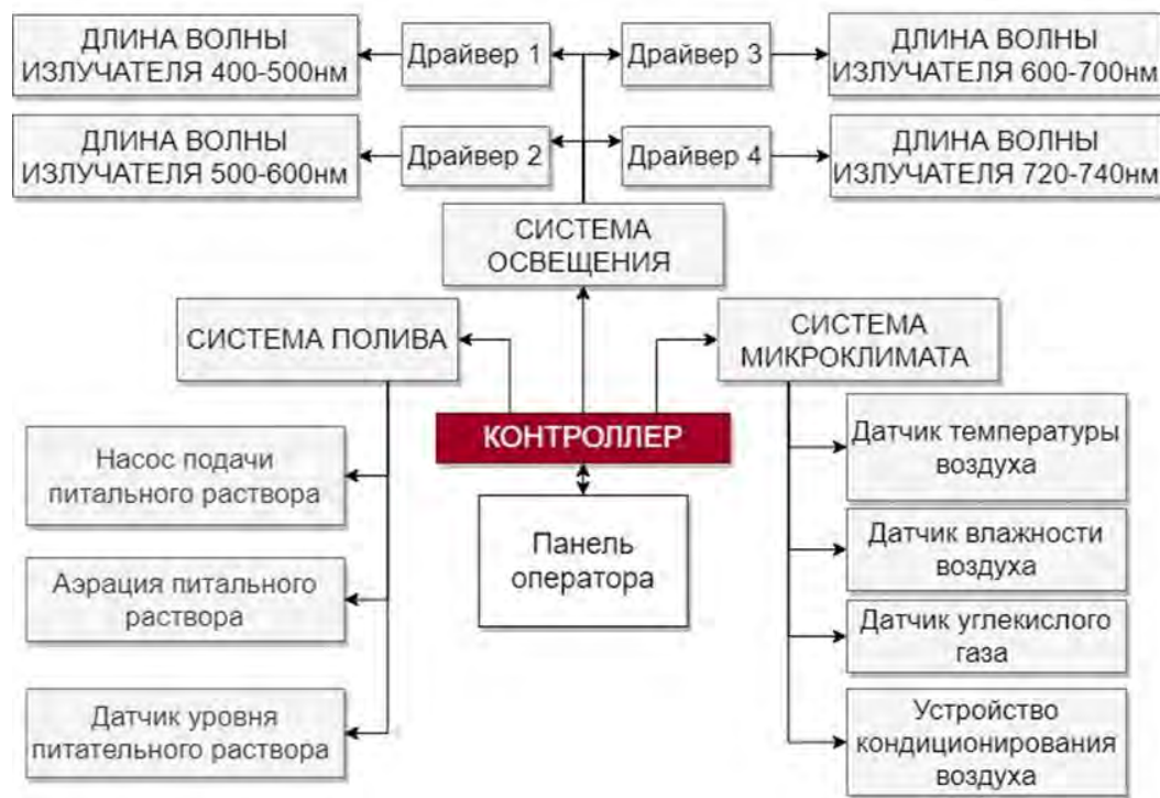
Рисунок 13 – Структурная схема модели климатической камеры управляемого выращивания овощных культур
