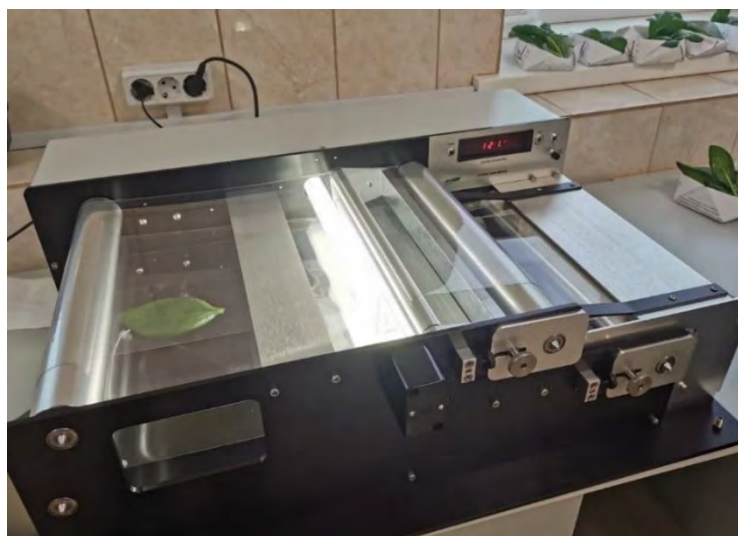
Рисунок 34 – Определение площади листовой поверхности листьев шпината на фотопланиметре LI-COR - LI-3100 AREA METER
