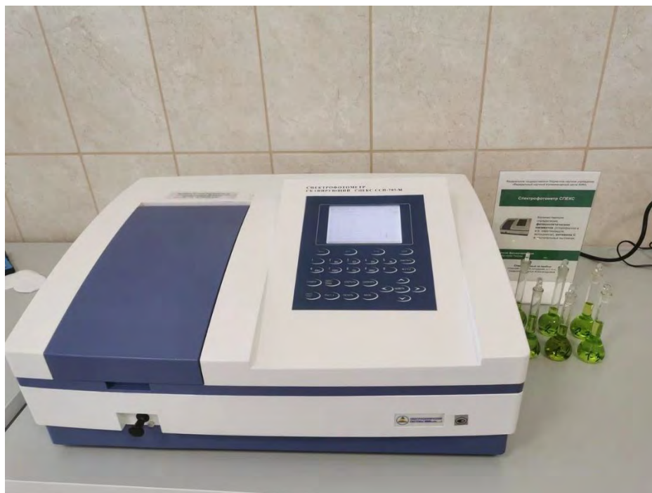
Рисунок 36 – Определение пигментов спектрометрическим методом на спектрофотометре СПЕКС ССП-705
