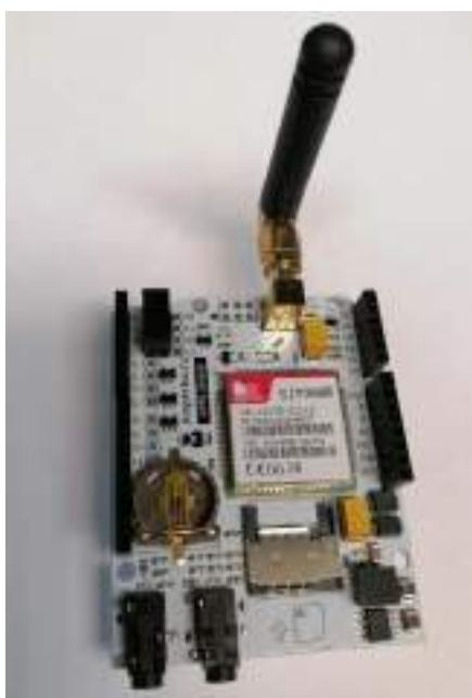
Рисунок 3.34 – GSM модуль SIM900R [109]
