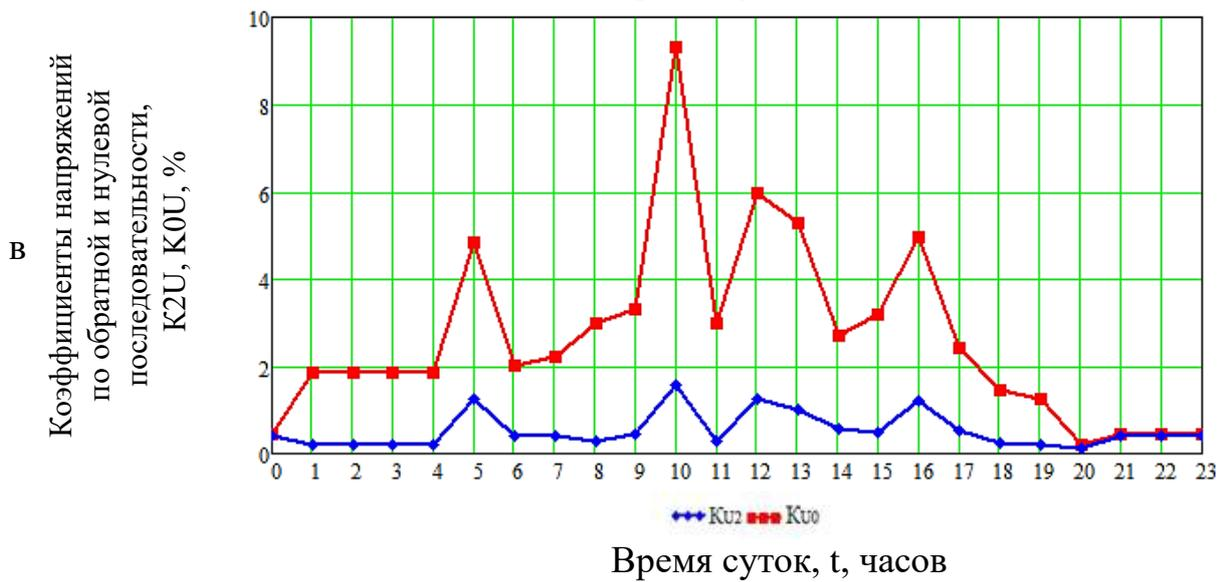
Рисунок 2.16 – Временные диаграммы изменения коэффициентов обратной и нулевой последовательностей напряжения при различной нагрузке: *а* – производственной; *б* – административной; *в* – коммунально-бытовой;
