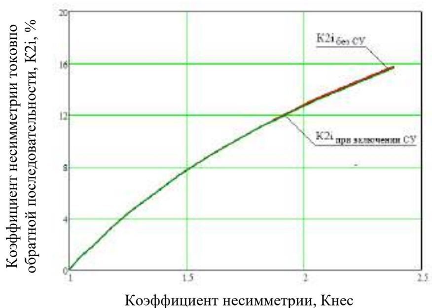
Рисунок 3.24 – График изменения коэффициента несимметрии токов по обратной последовательности от уровня несимметрии для трехфазной симметричной и трехфазной нагрузки
