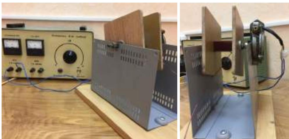
Рисунок 4.5 – Процесс изготовления катушки индуктивности
