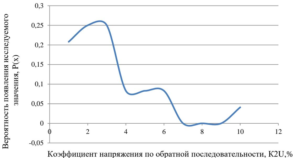
Рисунок 2.19 – Полигон распределения коэффициента обратной последовательности напряжения при коммунально-бытовой нагрузке
