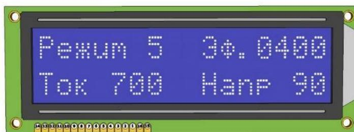
Рисунок 65– Структура отображения данных на дисплее
