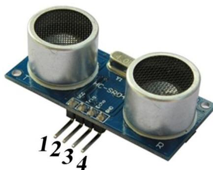
Рисунок 3.7 – Ультразвуковой модуль HC-SR04
