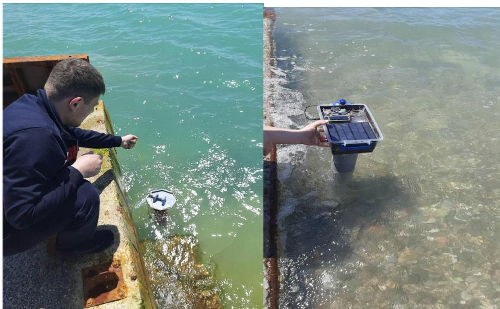
Рисунок 4.12 — Экспериментальные модели измерителя параметров волн и устройство для преобразования волн
