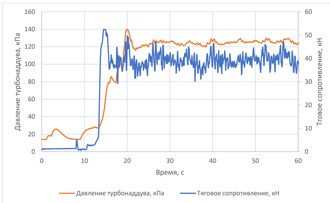
Рисунок 48 – Диаграммы значений тягового сопротивления бороны Challenger Sunflower 1435-29 и давления турбонаддува двигателя трактора Versatile 2375 на лушении стерни озимой пшеницы
