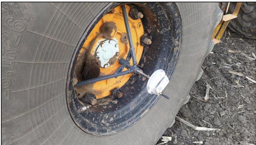
Рисунок 45 – Установка беспроводного датчика буксования ИП-291 на ведущее колесо трактора К-700А
