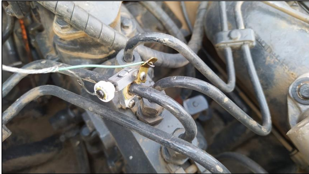
Рисунок 44 – Установка пьезоэлектрического датчика на топливопровод высокого давления двигателя ЯМЗ-238НД трактора К-700А
