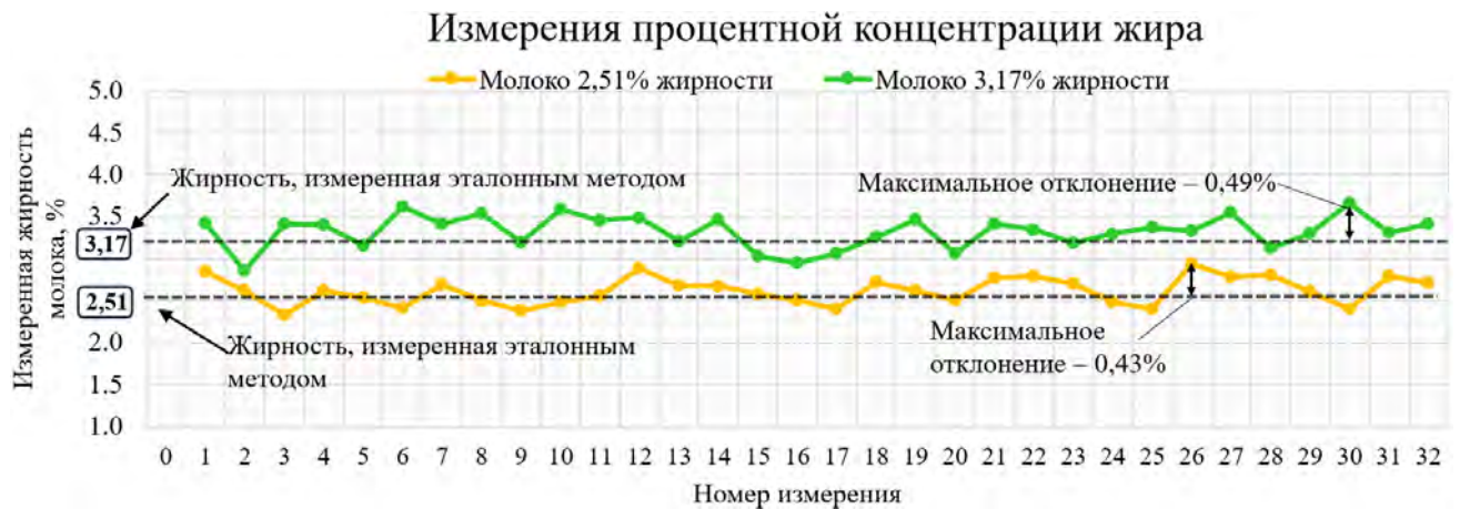
Рисунок 4.3 – Результаты испытаний точности устройства по измерению процентной концентрации жира в молоке
