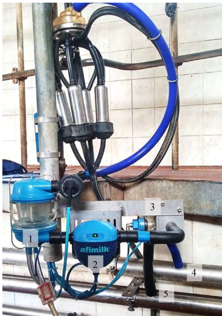
1 - молокомер, 2 – анализатор качества молока AfiMilk Afilab, 3 – клапаны для разделения молока, 4 и 5 – молочные линии для разделенного молока
