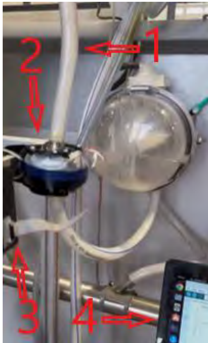
1 – молочный шланг, заполненный молоковоздушной смесью, 2 – модуль измерений устройства, 3 – модуль расчетов устройства, 4 – компьютер для сбора результатов
