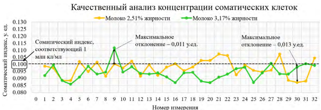
Рисунок 4.4 – Результаты испытаний точности устройства по проведению качественного анализа концентрации соматических клеток
