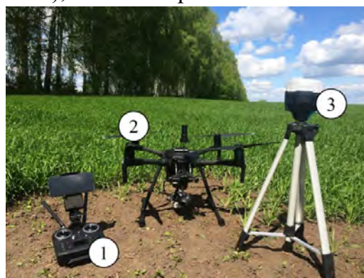
1 – пульт управления; 2 – БВС DJI Matrice 200 v2 с ГНСС L1/L2 приёмником; 3 – ГНСС приёмник EMLID Reach RS2 Рисунок 27 – Система мониторинга сельскохозяйственных биообъектов
