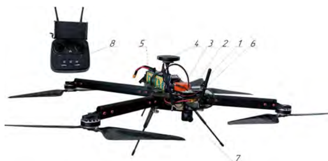
1 – приемник с телеметрией; 2 – рама с силовой частью и пропеллерами; 3 – полётный контроллер; 4 – модуль геопозиционирования; 5 – аккумулятор; 6 – плата разводки питания; 7 – FPV камера; 8 – пульт управления
