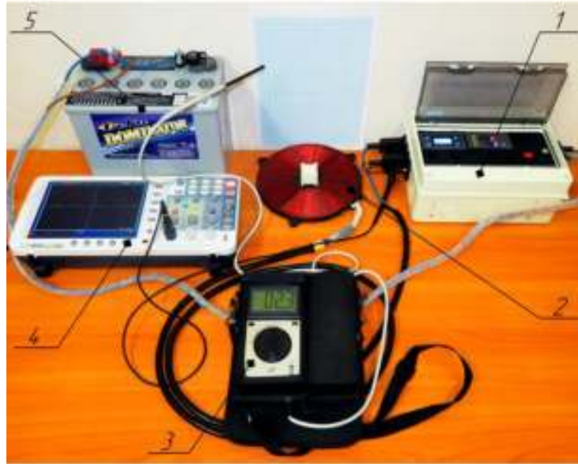
1 – автоматизированный аппарат МИО, 2 – магнитный индуктор, 3 – миллитесламетр портативный универсальный (ТПУ-01), 4 – осциллограф цифровой АКИП 4122/1, 5 – АКБ.
