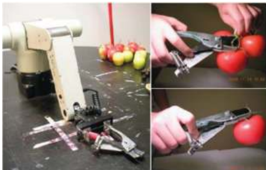
Рисунок 1.55 – Захват с плоскогубцами и резаком
