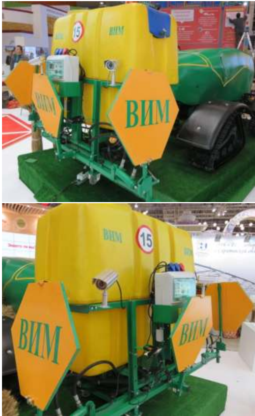
Рисунок 3.10 – Адаптер МИО к роботизированному энргосредству с опрыскивателем-гербицидником
