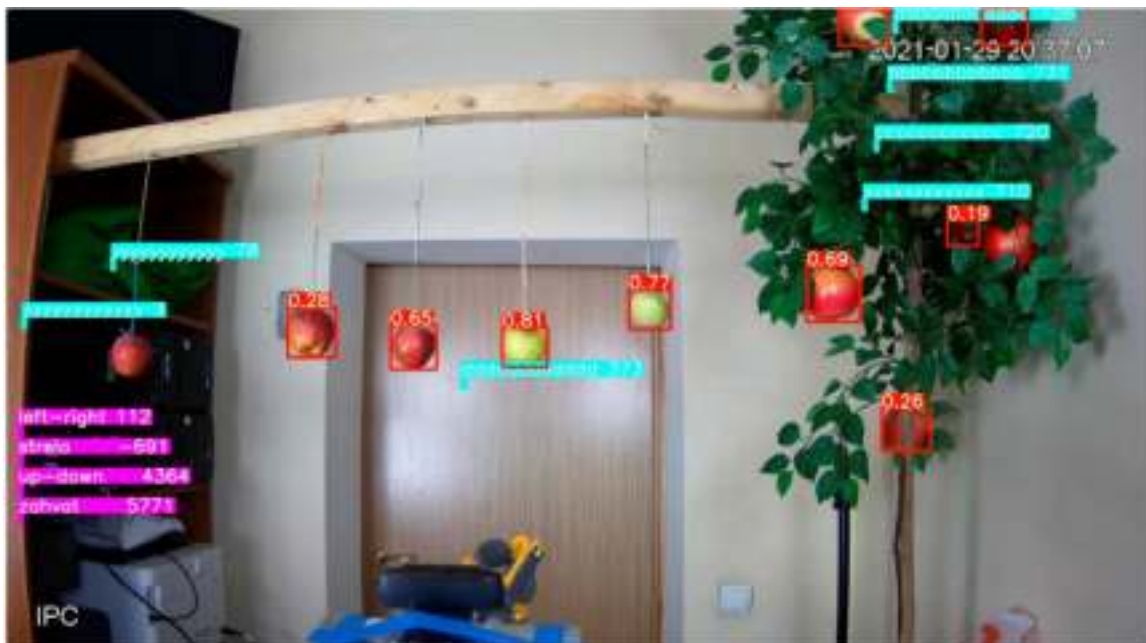
Рисунок 4.58 – Результаты идентификации и определения их координат плодов яблони и обработки изображений с помощью нейронной сети
