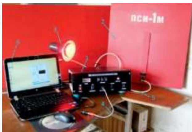
Рисунок 1.36 – Стимулятор магнитно-импульсный «СМИ-5» (ФГБНУ ВСТИСП, г. Москва): 1- блок электронный, 2 - индуктор, 3 - излучатель света, 4 – кабель индуктора, 5 – кабель сигнальный, 6 – ноутбук, 7 – манипулятор (мышь)
