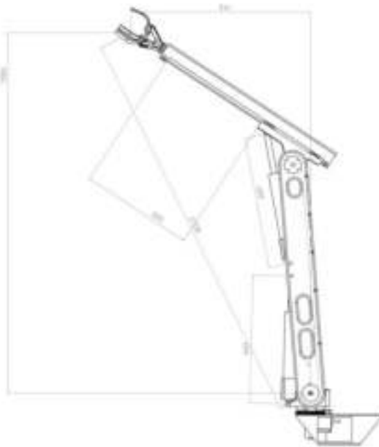
Рисунок 3.35 – Габаритные характеристики роботизированного манипулятора
