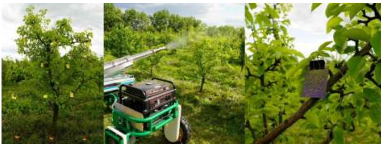
Рисунок 4.51 – Закрепленные на дереве карточки водочувствительной бумаги после попадания капель водного раствора СЗР
