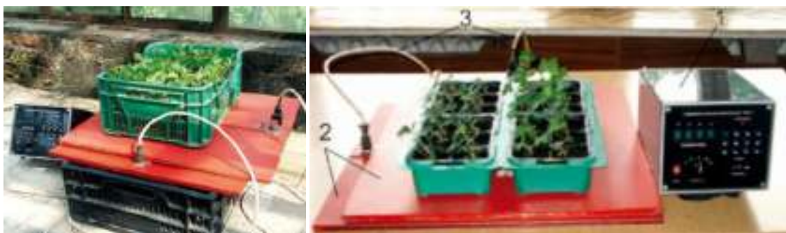
Рисунок 1.35 – Стимулятор магнитно-импульсный «СМИ-4» (ФГБНУ ВСТИСП, г. Москва): 1 - блок электронный; 2 - индукторы; 3 - кабели индукторов
