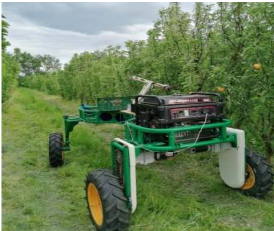
Рисунок 4.43 – Полевая проверка алгоритма управления движением роботизированной платформы
