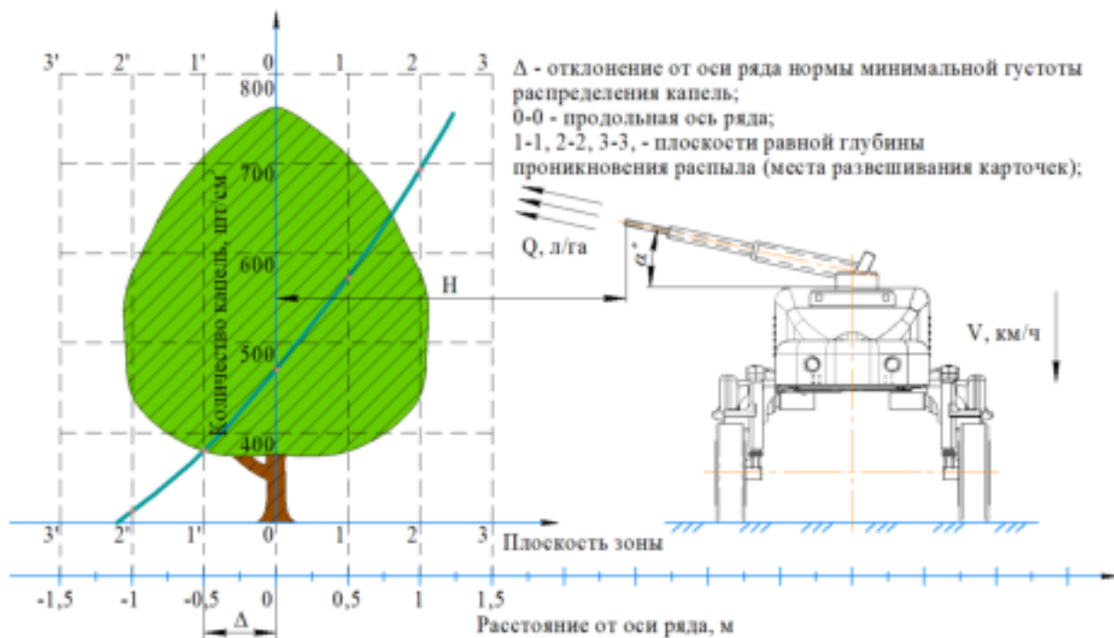
Рисунок 4.55 – Проницаемость капель горячего тумана по проекции кроны дерева
