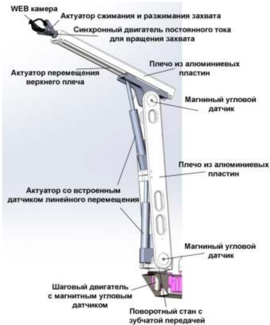
Рисунок 3.55 – 3D модель роботизированного манипулятора
