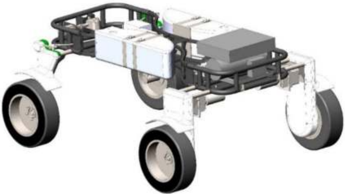
Рисунок 3.21 – 3D модель роботизированной садовой платформы без облицовки
