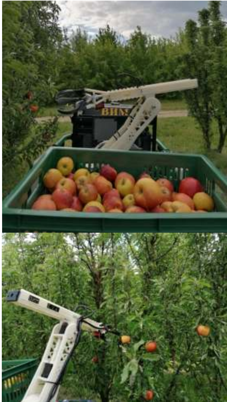
Рисунок 4.62 – Процесс съема плодов роботизированным манипулятором
