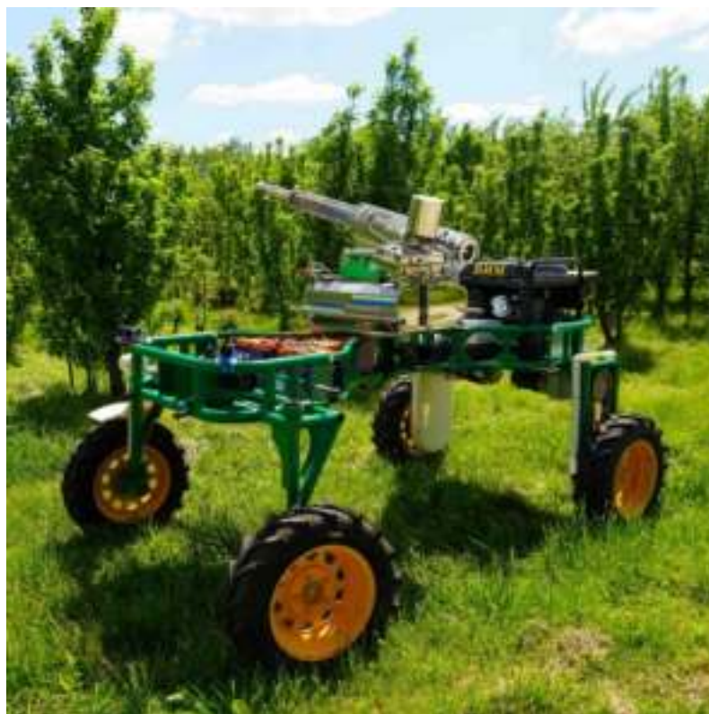
Рисунок 4.50 – Роботизированная платформа с установленным на нее аэрозольным генератором тумана
