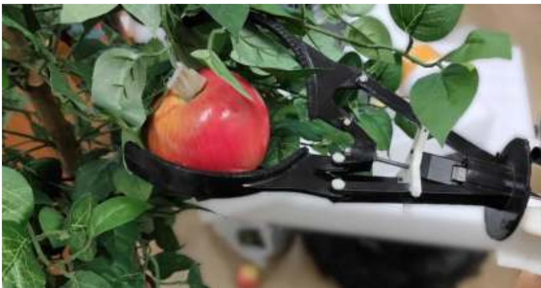
Рисунок 4.59 – Процесс проведения лабораторного эксперимента, захват плода разработанным устройством
