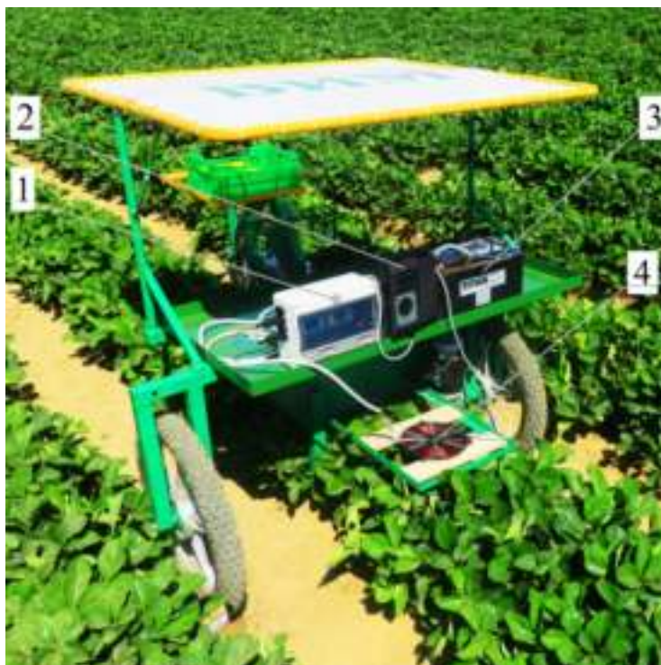
1 – автоматизированный аппарат МИО, 2 – миллитесламетр портативный универсальный (ТПУ), 3 – АКБ, 4 – магнитный индуктор (плоская спиральная катушка)
