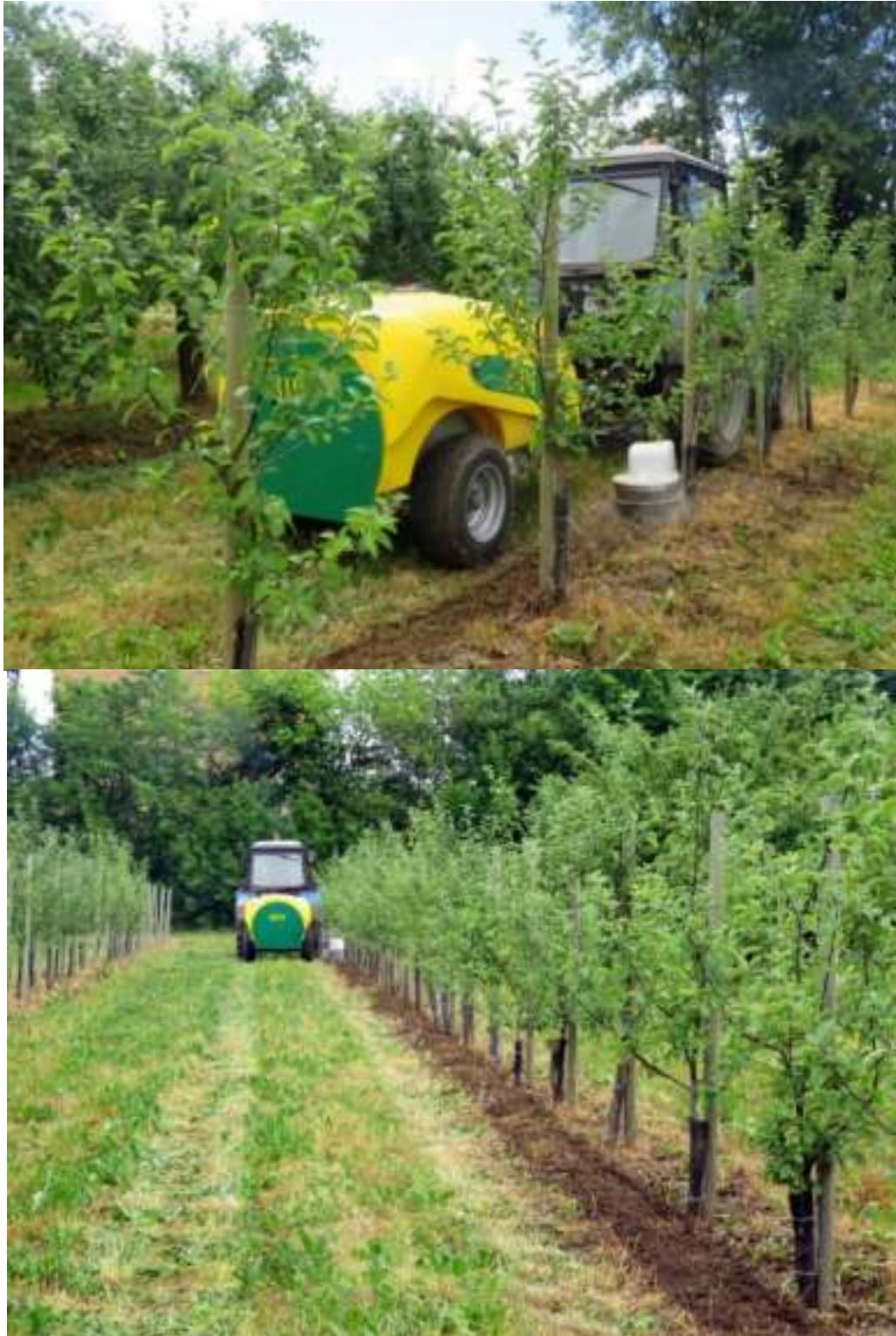
Рисунок 4.36 – Выполнение устройством технологической операции гидравлического удаления сорной растительности
