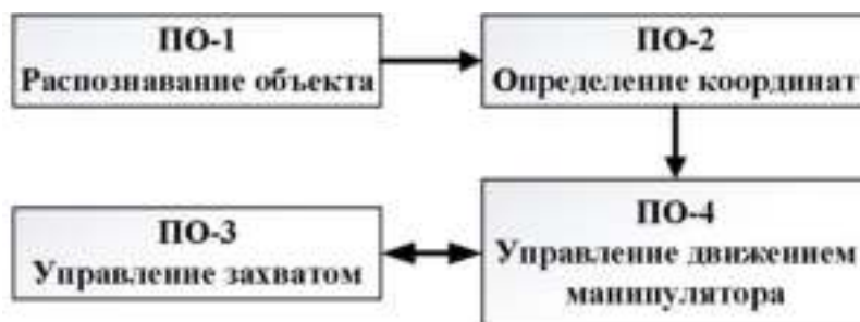
Рисунок 3.61 – Структура программного обеспечения роботизированного комплекса для съёма плодов
