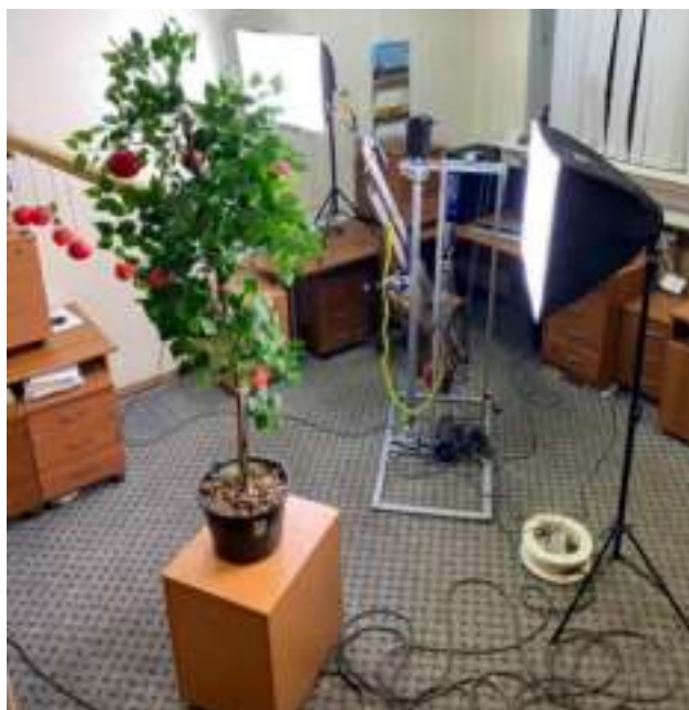
Рисунок 4.57 – Лабораторные исследования роботизированного манипулятора при определении координат плодов
